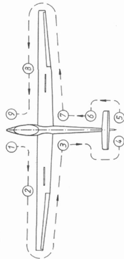
Achten Sie beim Rundgang um das Segelflugzeug auf Lackrisse, Beulen und Unebenheiten in der Oberfläche; im Zweifelsfalle setzen Sie sich mit einem Fachmann in Verbindung.
